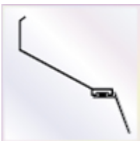
4 Stück a 3500 mm Wandanschlußprofil mit Aufkantung zum Versiegeln und Lippendichtung
