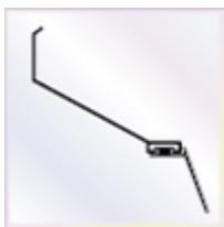
Wandanschlußprofil mit Aufkantung zum Versiegeln und Lippendichtung
