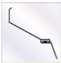
Wandanschlußprofil mit Aufkantung zum Versiegeln und Lippendichtung
