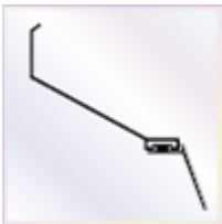
3 Stück a 5000 mm Wandanschlußprofil mit Aufkantung zum Versiegeln und Lippendichtung
