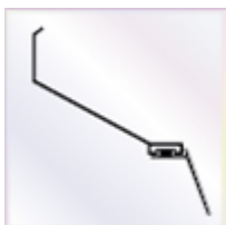
7 Stück a 2500 mm Wandanschlußprofil mit Aufkantung zum Versiegeln und Lippendichtung
