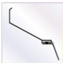
8 Stück a 2500 mm Wandanschlußprofil mit Aufkantung zum Versiegeln und Lippendichtung
