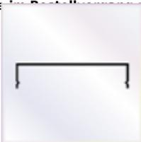
8 Stück a 4000 mm **Wandanschlußprofil** mit Aufkantung zum Versiegeln und Lippendichtung
