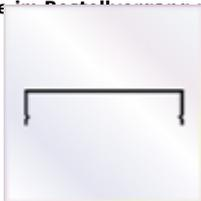
9 Stück a 4500 mm **Wandanschlußprofil** mit Aufkantung zum Versiegeln und Lippendichtung
